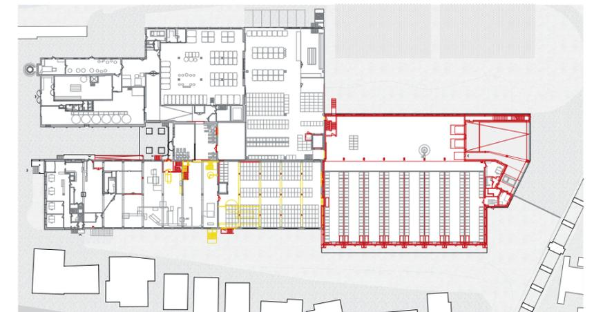
Grundriss Erdgeschoss: rechts in Rot die neue Halle, Gelb bedeutet Abbruch.
